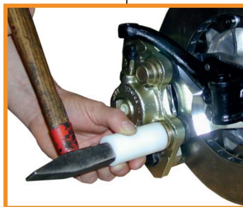
Fig. 7 Kunststoffdorn und Staubschutzkappen-montage/ Mounting of the dust covers with the installation tool
