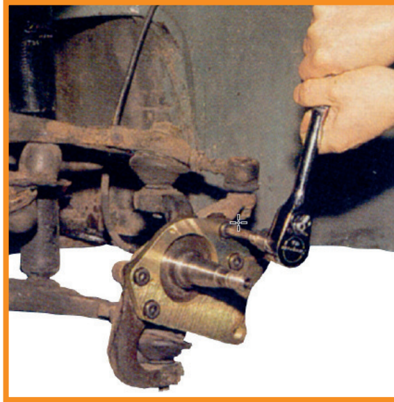
Fig. 4 Montierte Bremssattelhalteplatte/ mounted special caliper bracket
