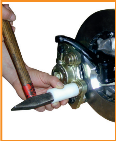
Fig. 6 Kunststoffdorn und Staubschutzkappen-montage/ Mounting of the dust covers with the installation tool
