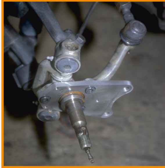
Fig.4 Montierte Bremssattelhalteplatte/ mounted special caliper bracket
