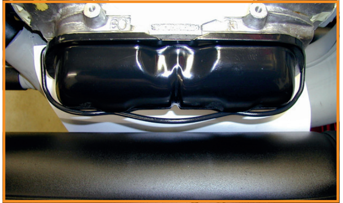
Fig. 5 Ausrichten des Schalldämpfers parallel zum Zylinderkopf / Ventildeckel Align the silences parallel to the cylinder head / valve cover
