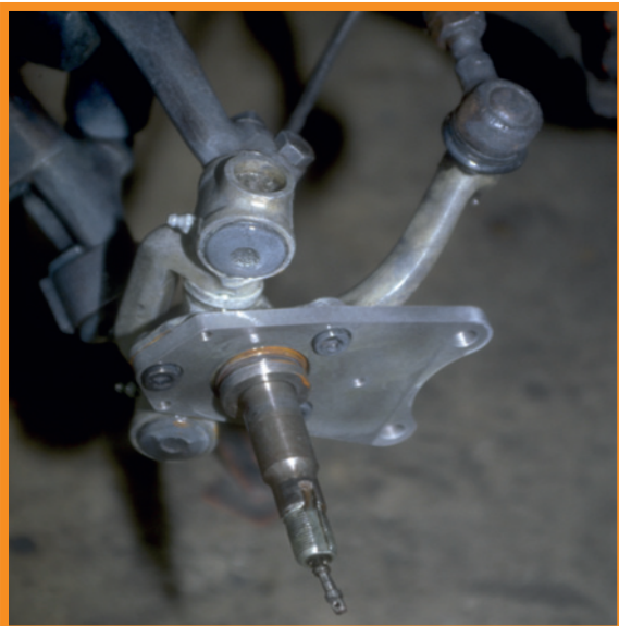
Fig.4 Montierte Bremssattelhalteplatte/ mounted special caliper bracket
