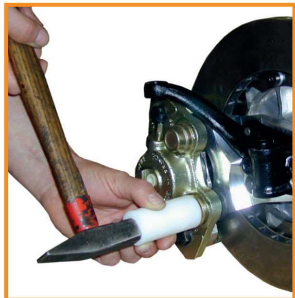
Fig. 6 Montage der Staubkappen/ Installing the dust covers
