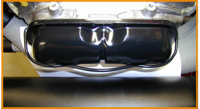
Fig. 5 Ausrichten des Schalldämpfers parallel zum Zylinderkopf / Ventildeckel Align the silences parallel to the cylinder head / valve cover
