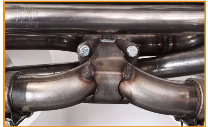
Verbindung Fächerkrümmer/Schalldämpfer Connection Manifold/Silencers
