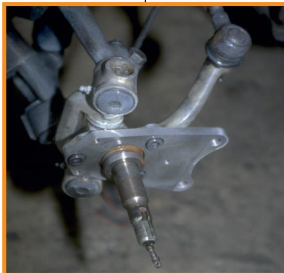
Fig.4 Montierte Bremssattelhalteplatte/mounted special caliper bracket
