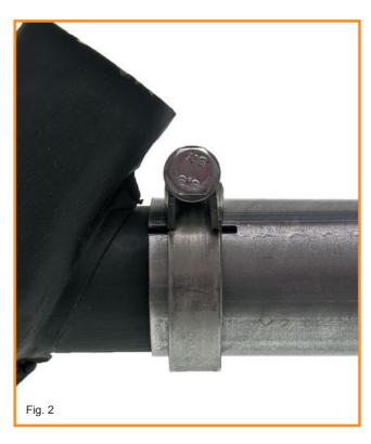
ANMERKUNG: Tragen Sie unbedingt etwas Kupferpaste auf die Enden der Krümmerrohre Zyl. 3 & 4 auf bevor diese in den Kollektor geschoben werden.
