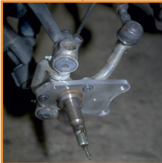
Fig.4 Montierte Bremssattelhalteplatte/
