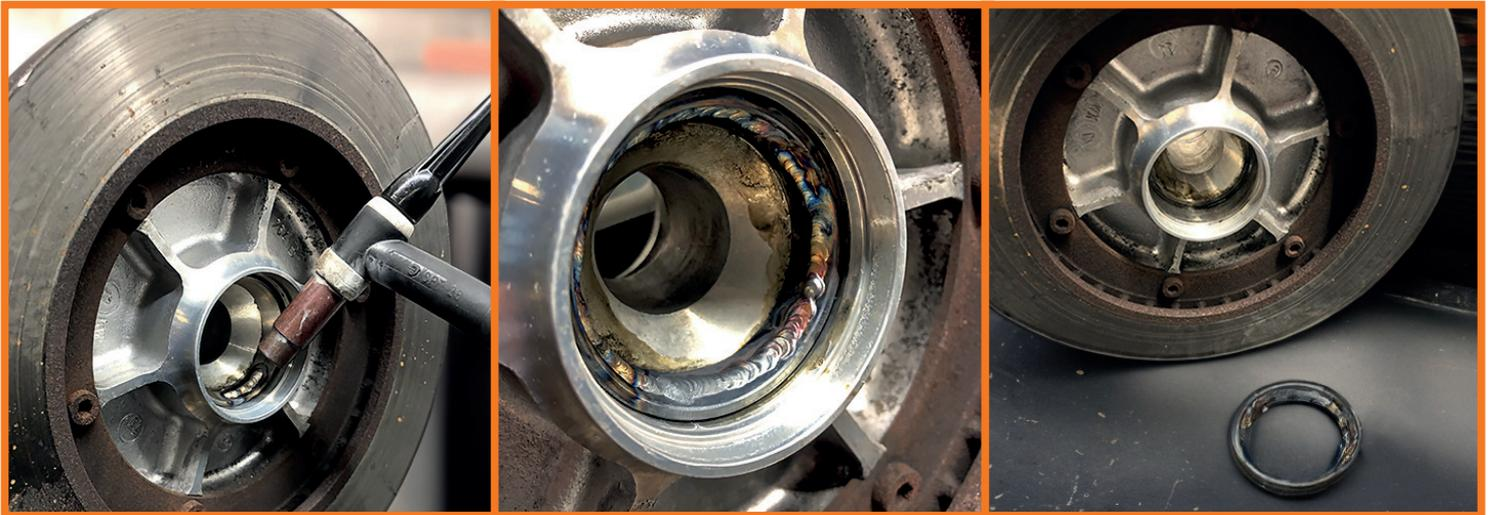
Für den Fall, dass Sie keinen Auszieher zur Hand haben, gibt es die Möglichkeit, mit Hilfe eines Schweißgerätes eine „geschlossene Naht“ auf die innere Lauffläche des Radlagers zu schweißen. Durch die Naht schrumpft der Außendurchmesser der Lagerschale und lässt sich somit einfach entnehmen. Vor dem Schweißen der zweiten Lagerschale muss die Nabe vollständig abgekühlt sein. Reinigen Sie sorgfältig den Lagersitz, bevor das neue Lager eingepresst wird.
